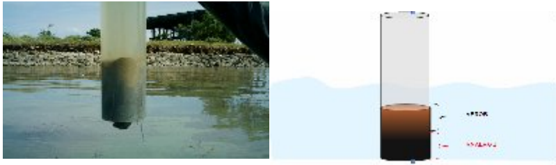
Gambar 2. Corer: Alat untuk mengambil sampel sedimen (aerob dan anaerob). Figure 2. Corer: Instrument for sampling sediment.
